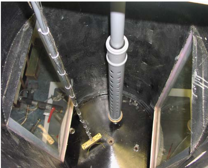
Abb. A17: Blick in den Versuchsspeicher mit eingebauter Schichtbeladeeinrichtung und Temperaturlanze
