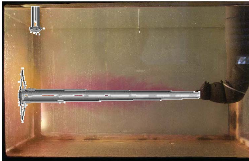
Abb. 5.5: Dargestellt ist die Fotografie des Behälters und die mit der Simulation berechneten Isotachen bei \Delta T = 0\text{K} .
