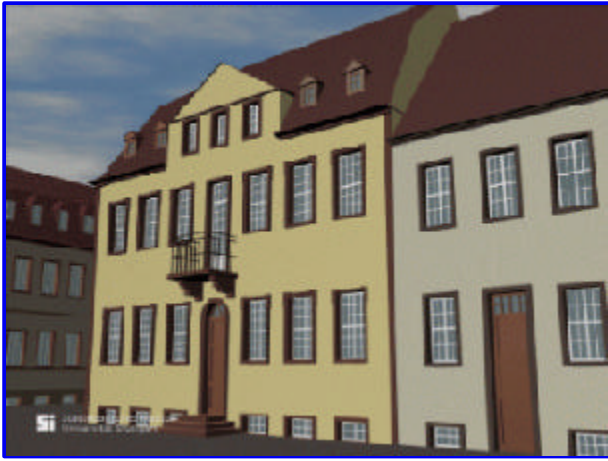
Abb. 7: Schematische Abbildungen zu den drei Level of Details: (1) reine Hüllkörper am Beispiel von Stuttgart 21, (2) Körper mit Fototextur, (3) reine Geometrikörper mit Fassaden- und Dachdetails
