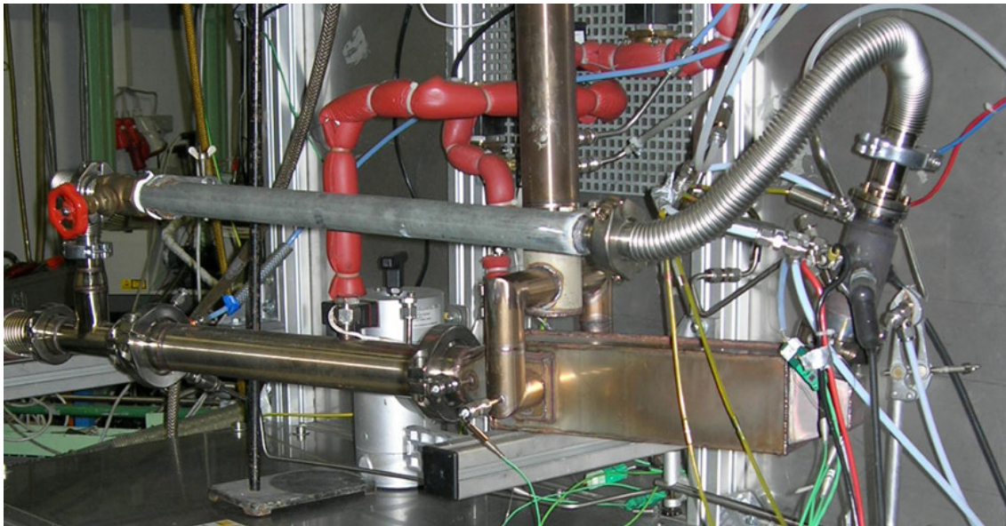
Abb. 11: Foto von Brenner Typ 2 am Prüfstand mit Abgasnachbehandlungseinheit [9]
