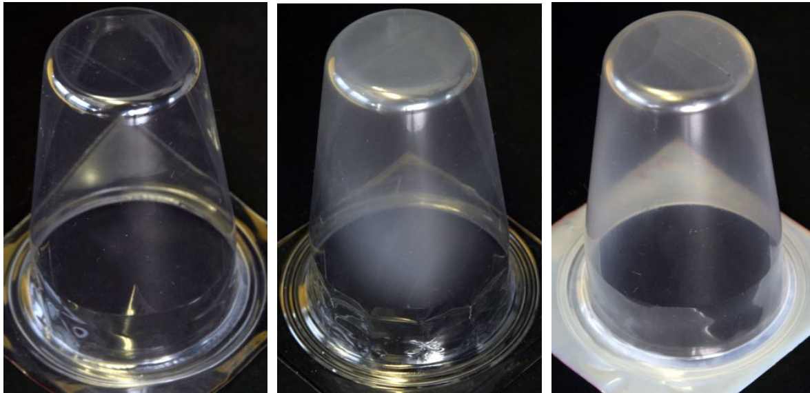
ABB. 2: EINFLUSS DER VERARBEITUNGSPARAMETER AUF DIE OPTISCHEN EIGENSCHAFTEN VON FORMTEILEN AUS PET
