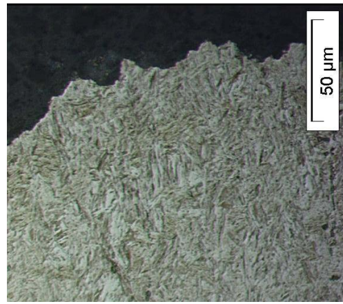
Detail gezackter Rissverlauf Zugprobe
