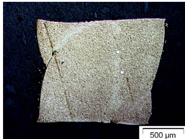
Bild 7.1: Versagte Ringprobe hergestellt aus einem Niet
