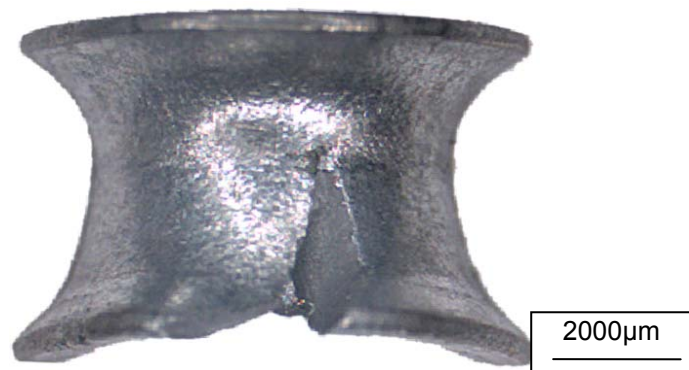
Bild 5.35: Aufgerissener Niet in Fugerichtung
