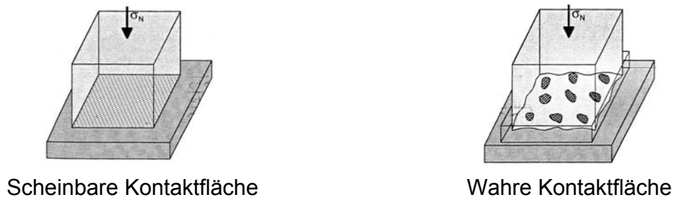
Bild 2.12: Scheinbare und wirkliche Kontaktfläche /30/
