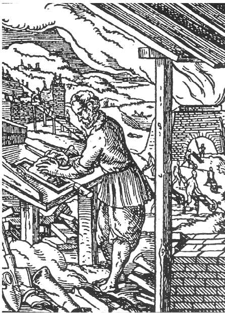
Bild 3.1: Handstreichen von Ziegeln – Mittelalterliche zeitgenössische Darstellung. Aus Egermann und Mayer, 1989
