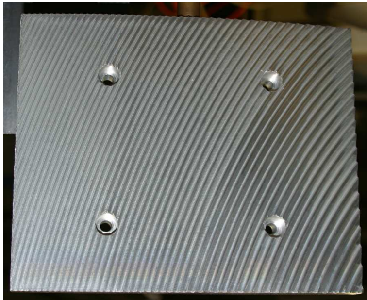
Abbildung 5.32: Foto des fertigen holographischen Spiegels aus Aluminium. Da Gitter 2. Ordnung verwendet wurden, liegen die Nuten nur halb so dicht wie die Phasendurchgänge in Abb. 5.31.
