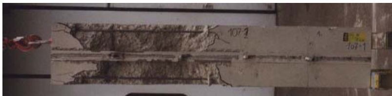
Bild 7.33: Betonausbruchkegel des Versuchs 107-2 mit h_{ef} = 100 mm
