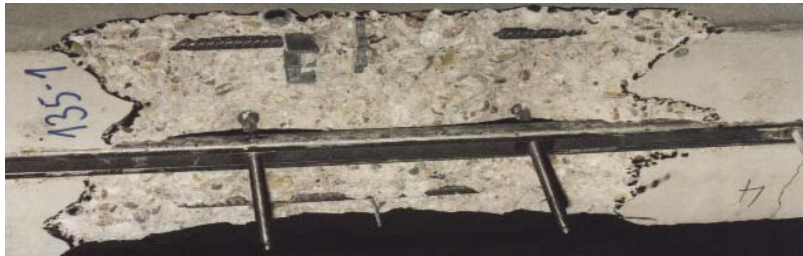
Bilder 7.30 a bis c: Ausbruchkegel der Versuche 131-2, 133-1 und 135-1
