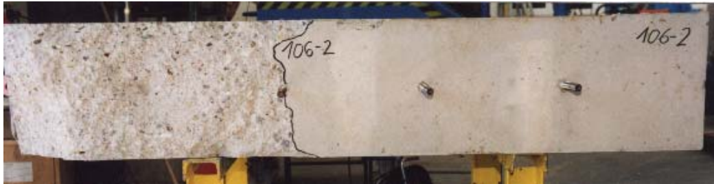
Bild 7.24: Ausbruchkegel der Kopfbolzen (Versuch 106-2)
