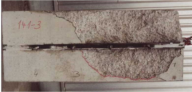
Bild 7.28: Ausbruchkegel des Versuchs 141-3 ( c_2 = c_3 = 300 mm)
