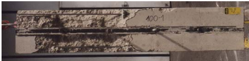
Bild 7.32: Betonausbruchkegel des Versuchs 100-1 mit h_{ef} = 85 mm
