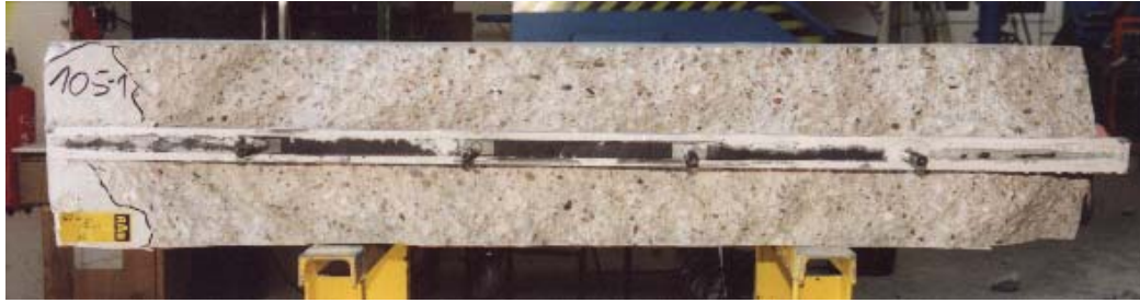
Bild 7.23: Ausbruchkegel der Ankerschiene (Versuch 105-1)
