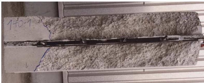
Bild 7.27: Ausbruchkegel des Versuchs 140-1 ( c_2 = c_3 = 210 mm)
