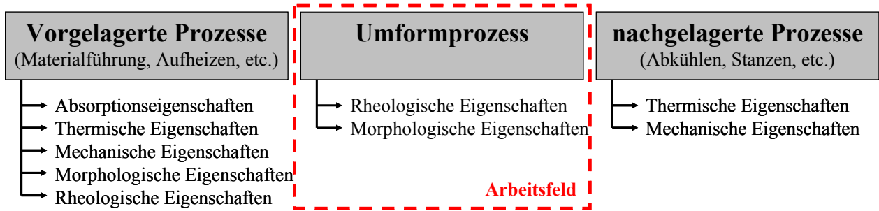
Abb. 5: Einfluss der Halbezeugeigenschaften auf die Thermoformbarkeit
