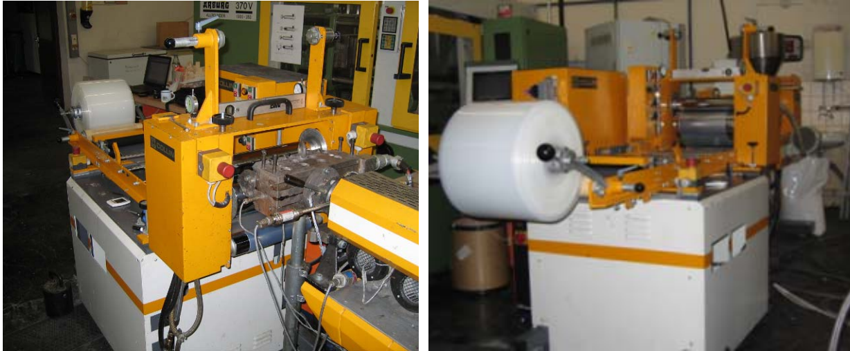
Abb. 20: Extruder mit nachgelagerter Chill-Roll-Anlage
