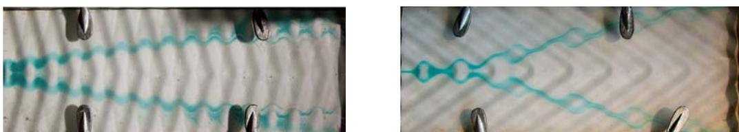
Abbildung 4.11: Symmetrische Strömungen im Plattenspalt bei  $Re_h = 1$ ;
