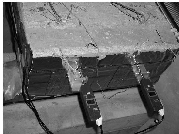
Abbildung 6.41: Wegnehmer für die Schlupfmessung am Ende des Trägers
