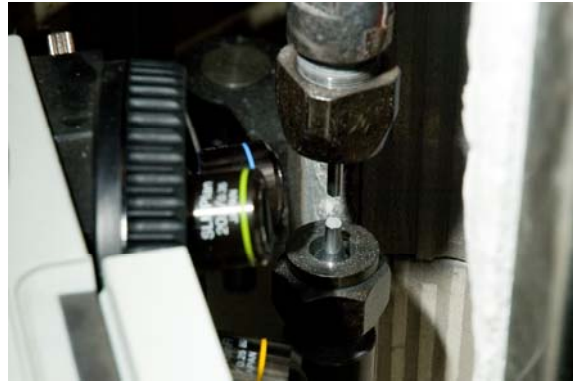
Bild 67: Mobiles Lichtmikroskop zur Dokumentation der Ermüdungsschädigung an den Mantelflächen von AlSi12Cu4MgNi2
