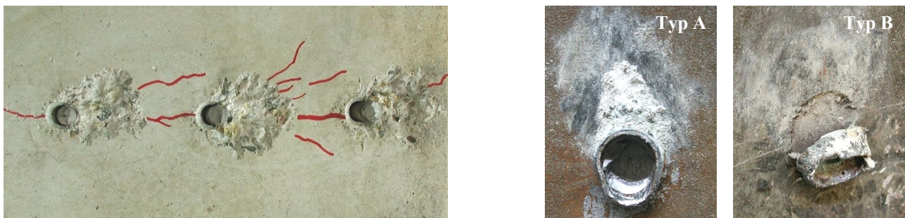
Bild 8-57. Ermüdungsverhalten liegender Kopfbolzen unter Längsschub
