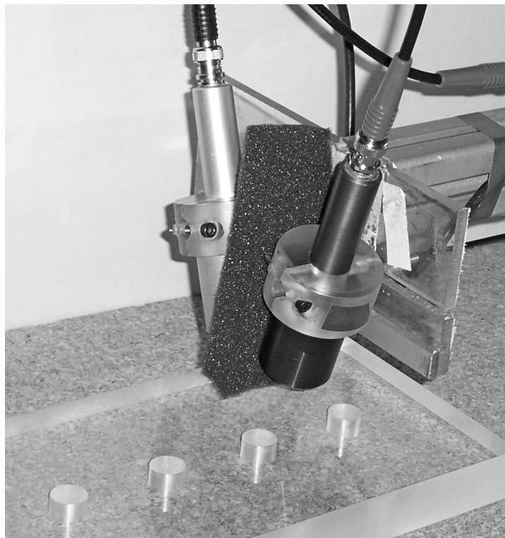
Abb. 5.29: PMMA-Sacklochprobe und FSRM-Sensor (392 kHz Prüfköpfe).
