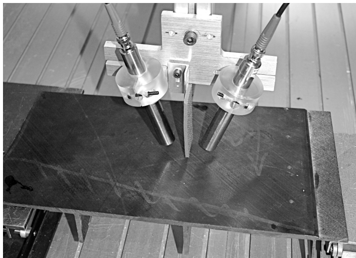
Abb. 5.4: Foto des Aufbaus für die FSRM an einer CFK-Probe.
