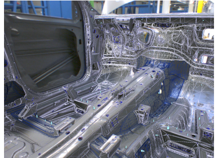
Abbildung 6.8: Überprüfung des Rohbaustandes
