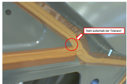
Abbildung 6.9: Überprüfung der Maßhaltigkeit der Dichtraupe
