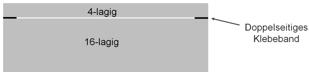
Abbildung 4.17: Kontaktwiderstandsmessung an zwei aufeinander gelegten CFK-Platten. Die Platten sind ringsum mit doppelseitigem Klebeband fixiert.
