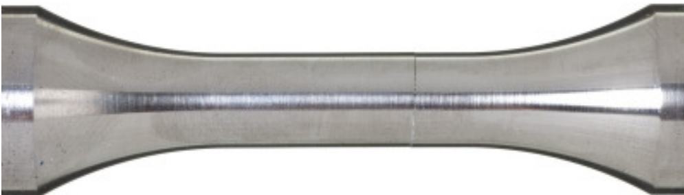
Bild 6.6 : Torsionsprobe 92.T12 mit Umfangsrissen nach 1600 Lastwechseln
