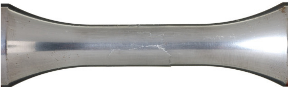
Bild 6.7 : Torsionsprobe 92.T14 einer Kombination aus Längs- und Umfangsriss nach 8850 Schwingspielen
