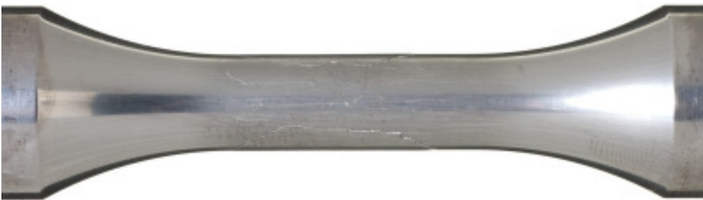
Bild 6.5 : Torsionsprobe 92.T13 mit Längsrissen nach 5240 Lastwechseln
