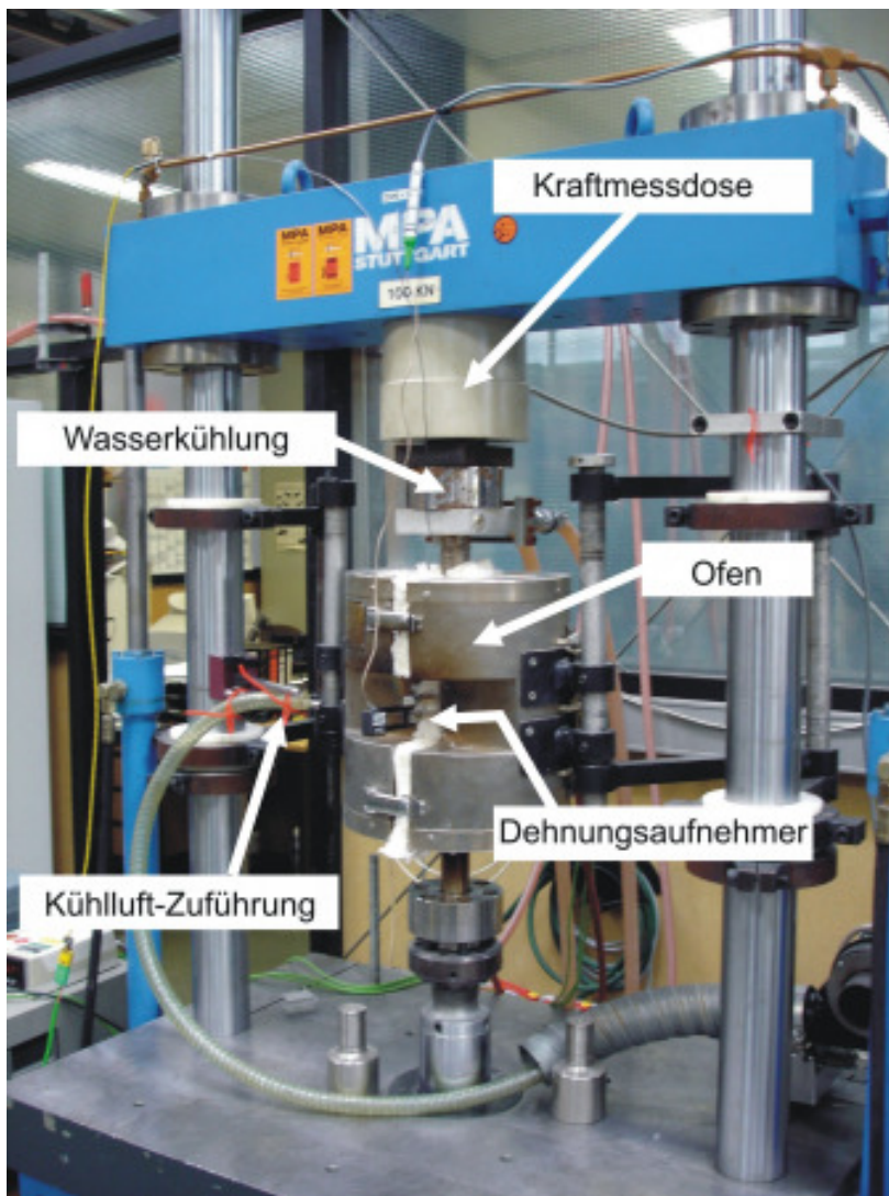
Bild 4.2: Prüfstand für einachsige Schwingversuche
