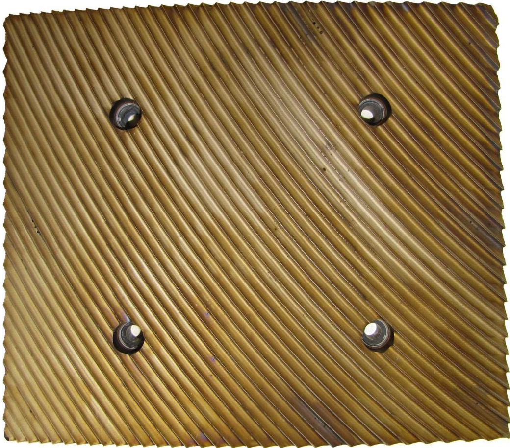
ABBILDUNG B.4: Holografischer Spiegel 2 für Gyrotron 6 (nach einer ASDEX-Upgrade-Kampagne).
