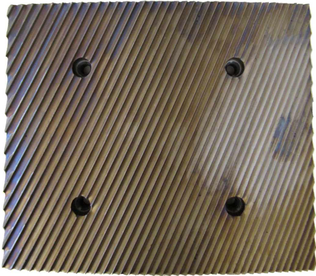
ABBILDUNG 7.6: Holografischer Spiegel 1 für Gyrotron 5 (nach einer ASDEX-Upgrade-Kampagne).
