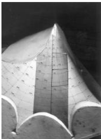
Bild 3.2: Zuschnittstreifen auf eine zweifach gekrümmte Oberfläche
