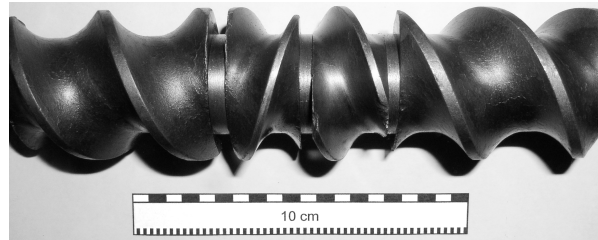
Bild 4.15: Um 90° versetzte Fördererelemente, sogenannte Segmentmischelemente
