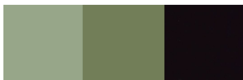
Abbildung 4.8: Durchlichtaufnahme der Flüssigkristallpolarisatoren OP3, OP4 (Nr.13) einzeln (links), parallel (mittig) und gekreuzt (rechts). Substrat PET-Folie, d = 60 \text{ } \mu\text{m} .
