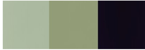
Abbildung 4.3: Durchlichtaufnahme des Polarisators HNCP37 einzeln (links), parallel (mittig) und gekreuzt (180° Spiegelung an der Flächennormale, rechts).
