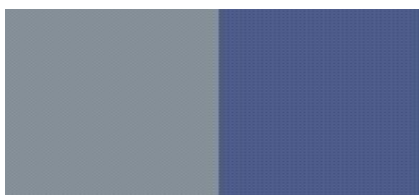
Abbildung 7.5: Matt weißer Körper unter transmittiertem Tageslicht bei Probe PA-3. Links Hellzustand. Rechts Dunkelzustand.
