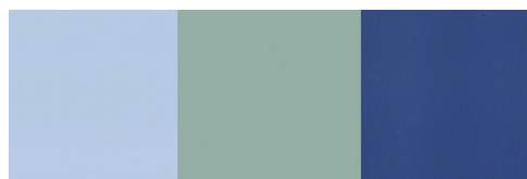
Abbildung 4.9: Durchlichtaufnahme der Flüssigkristallpolarisatoren N15-2, N15-4 (Nr.15) einzeln (links), parallel (mittig) und gekreuzt (rechts). Substrat aus Weißglas der Dicke 1.1 mm mit ITO- und SiO_2 -Beschichtung.
