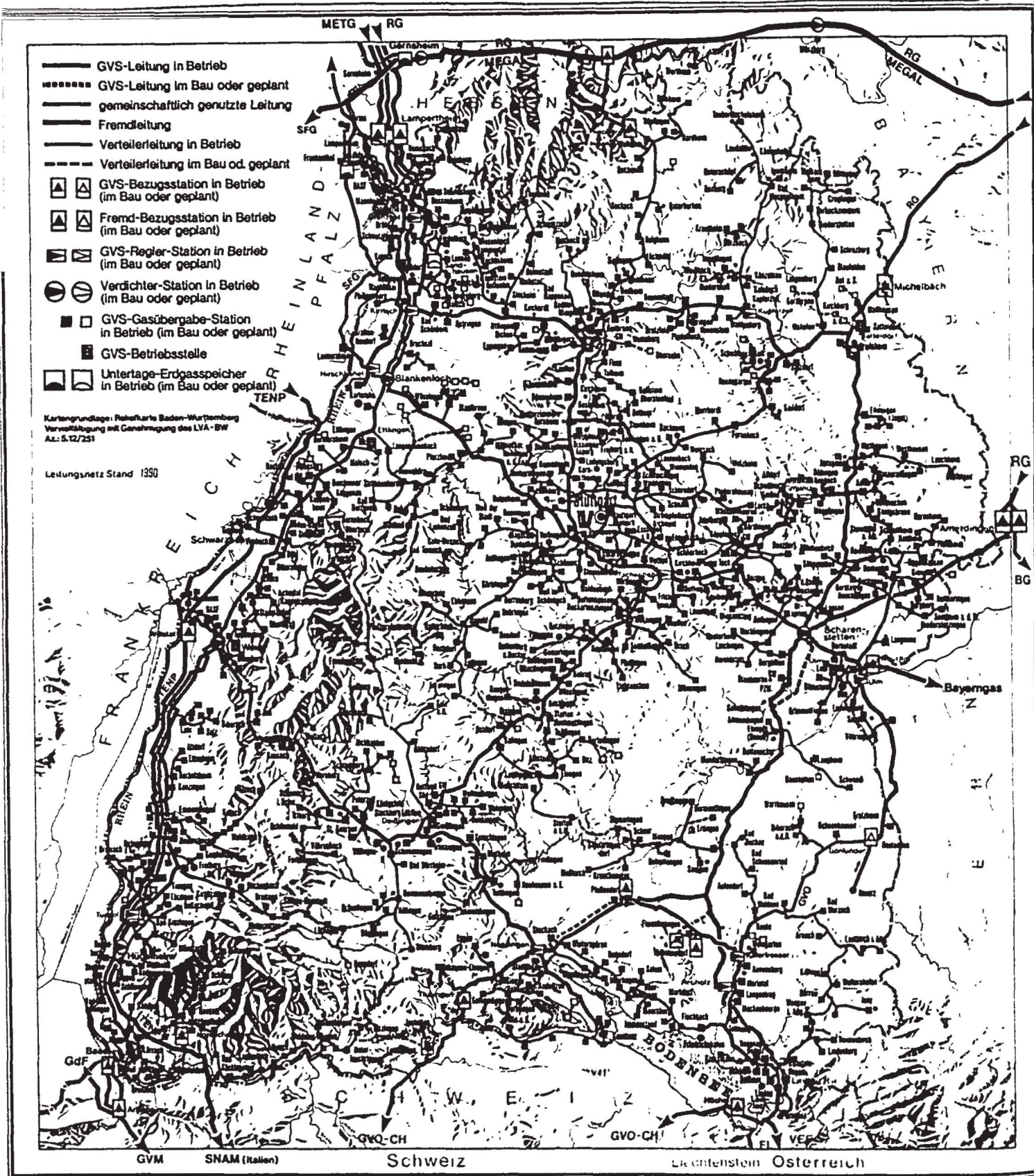
Abbildung 2.4-8: Erdgasleitungsnetz in Baden-Württemberg /2.4-31/
