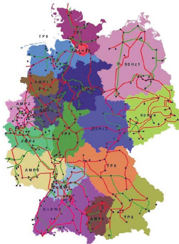
Abb. 3-2: Aufteilung des deutschen Übertragungsnetzes in Netzzonen, nach [189]
