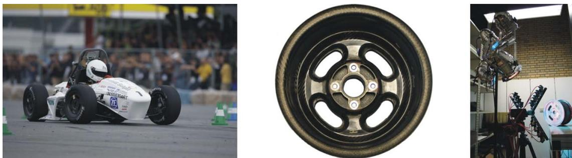
Abbildung 6.1: Formula Student Rennwagen 0711-3 (links), Innenansicht der Felgen (Mitte), Shearografiemessungen an den Composite-Felgen (rechts).
