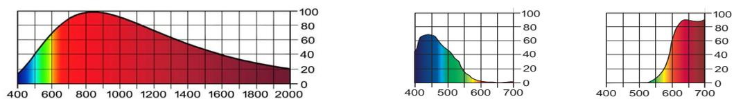
Abbildung 3.12: Spektrum einer Wolframglühwendel bei  $3300\text{ K}$  (links, berechnet) sowie Transmissionspektren der Lee-Filter HT141 und 135 (Mitte und rechts, [79]).
