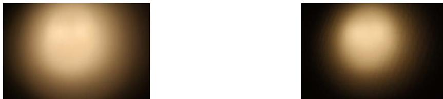
Abbildung 3.11: Ausleuchtung ohne (links) und mit Streulichtfilter (rechts).
