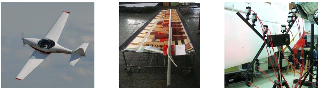
Abbildung 6.11: Ultraleichtflugzeug Fascination (links, mit freundlicher Genehmigung von René Mühlmeier), Fertigung der Tragfläche (Mitte), Prüfung der Blindverklebung (rechts).
