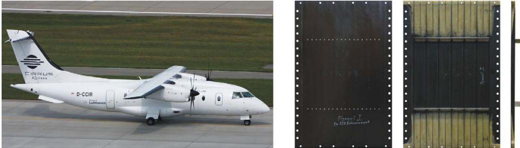
Abbildung 6.9: Dornier Do 328 (links, mit freundlicher Genehmigung von Gerry Stegmaier), CFK-Panel mit GFK-Aufdickung aus Beulversuch: Vorder-, Rück- und Seiten-Ansicht (rechts).
