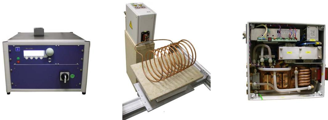
Abbildung 3.21: Induktionsanlage, bestehend aus MF-Generator (links) und Oszillator (Mitte und rechts).
