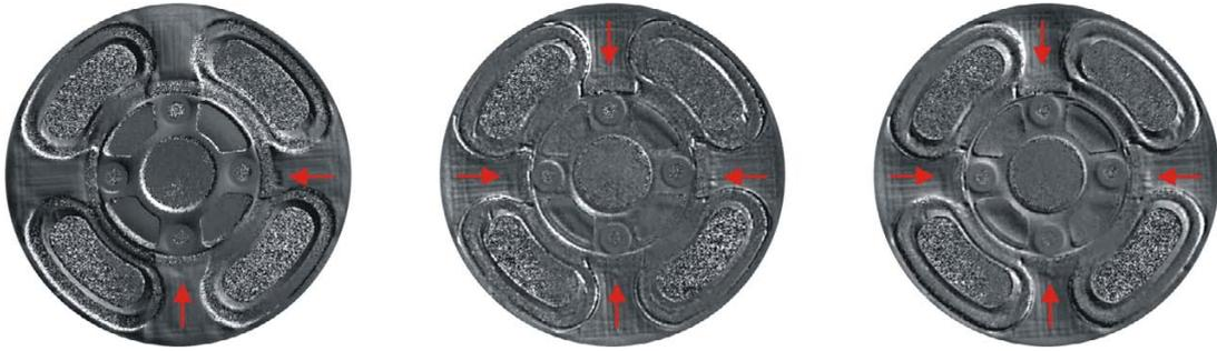
Abbildung 6.2: Beschädigte Felge, gemessen mit konventioneller Shearografie (links) und mit Lockin-Shearografie bei  $0,125\text{ Hz}$  (Mitte) und bei  $0,025\text{ Hz}$  (rechts).
