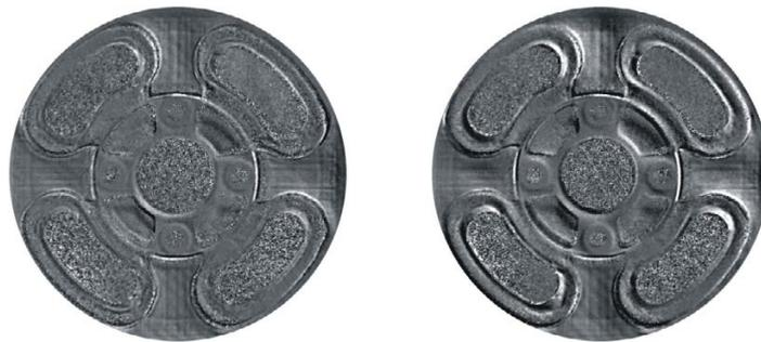
Abbildung 6.3: Intakte Felge, gemessen mit Lockin-Shearografie bei  $0,125\text{ Hz}$  (links) und bei  $0,025\text{ Hz}$  (rechts).
