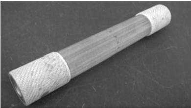
Abb. 5.4: GFK Rohrprüfkörper [Schm12a].
