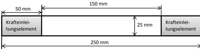
Abb. 5.3: Maße der Flachprüfkörper.
