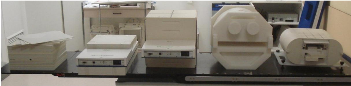
Abbildung 26: Verschiedene Phantomen für die patientenplanbezogene Qualitätssicherung für die IMRT. Von links nach rechts: RW3-Plattenphantom mit Ionisationskammeraufnahme, IBA MatriXX im RW3-Plattenphantom – IBA MatriXX im MultiCube – POM-Phantom mit Aufnahme für MatriXX (Eigenbau) – IBA IMRT-Phantom.
