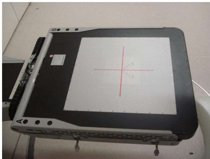
Abbildung 25: Foto eines EPID (ELEKTA IView GT) montiert auf einem Tragarm, die obere Abdeckung wurde entfernt.
