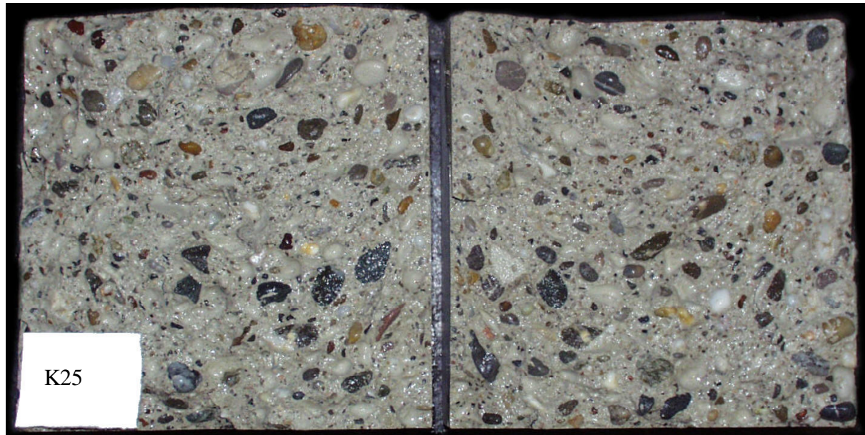
Bild A-63: Reste der Mischung K25 nach der Spaltzugprüfung
