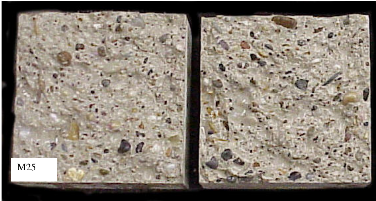
Bild A-67: Reste der Mischung M25 nach der Spaltzugprüfung
