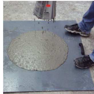
Bild 2-2: Durchführung des Setzfließversuches
