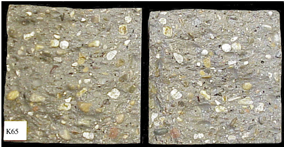
Bild A-65: Reste der Mischung K65 nach der Spaltzugprüfung
