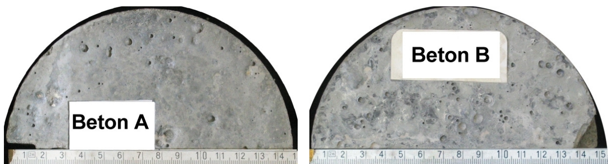
Bild 6.5: Draufsicht auf die Einfüllseite zweier Betonzylinder aus SVB ( \varnothing = 150 \text{ mm} , h = 300 \text{ mm} ); deutlich erkennbar sind die zurückgelassenen Krater
