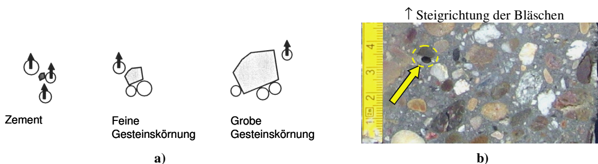
Bild 6.9: a) Behinderung der Luftbläschen beim Aufsteigen durch die Feststoffe [DE LARRARD, 1999] b) Schlifffeld eines selbstverdichtenden Betons mit 16 mm Größtkorn; der Pfeil deutet eine unter einem Gesteinskorn eingeschlossene Luftblase an
