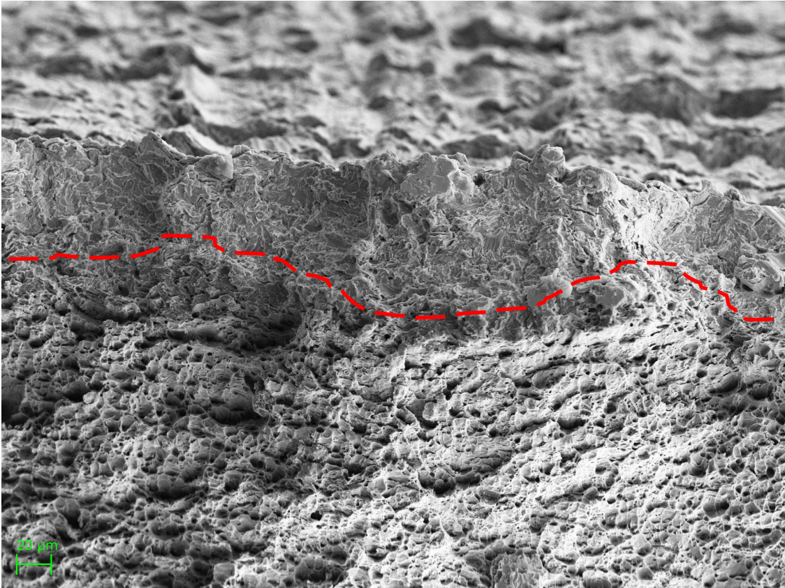
Abb. 56: Spaltbruchanteil im Randbereich der Bruchoberfläche des HC260LA.
