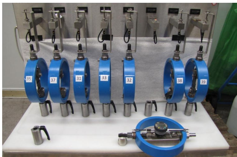
Abb. 26: Darstellung der Prüfapparatur und der Prüfringe.
