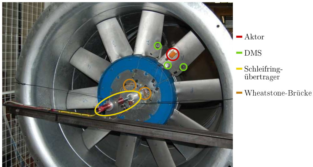
Bild 3.1: Axialgebläse mit Messanordnung des zweiten Versuchs
