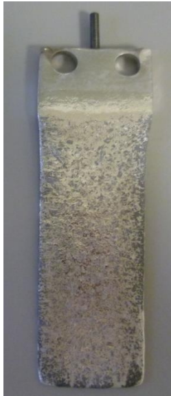
Abbildung 21: Magnesiumelektrode zur Untersuchung der Freisetzung
