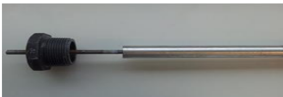
Abbildung 24: Oberer Teil der Mg-Elektrode mit Deckel für den Reaktor
