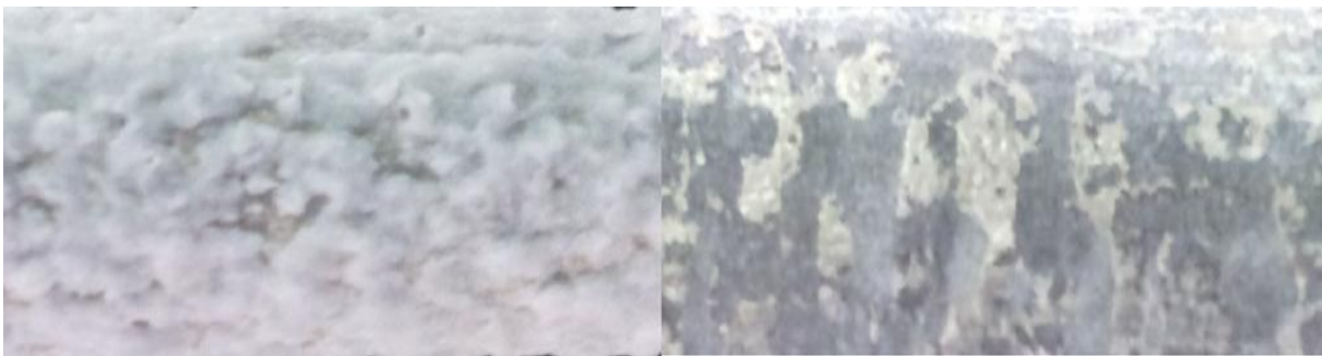
Abbildung 58: Passivierungsschicht der Magnesiumanode vor dem Spülen (links) und nach Säurereinigung (rechts)
