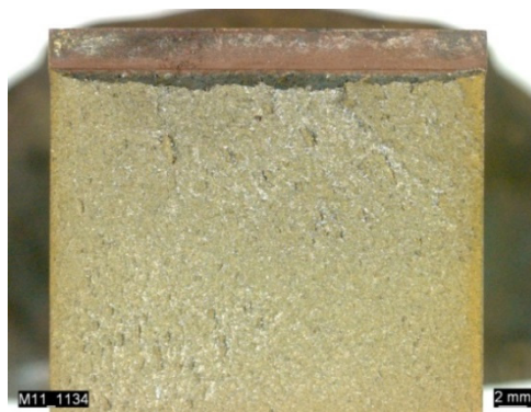
Bild 4.29: Bruchfläche der senkrecht zur Belastungsrichtung aufgebrochenen DENT30-Probe A252A1D3.
