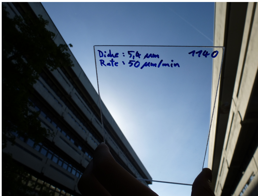
Abbildung 6.10: Foto eines mit \text{SiO}_x beschichteten GP Clear 099-Substrates. Die Schichtdicke beträgt d = 5,4 \mu\text{m} , was bei einer Beschichtungszeit von 6,5 \text{ s} einer Abscheiderate von 50 \mu\text{m}/\text{min} entspricht. Die Schichten sind auch bei sehr hohen Abscheideraten transparent und klar.
