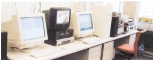
Abb. 6: Einrichtung zur Computer-Simulation von Systemen der Mobilkommunikation. Eine bitgenaue Simulation der übertragungstechnischen Verfahren ist möglich. Der Bitstrom kann in einen realen Empfänger (rechts) eingespeist werden.
