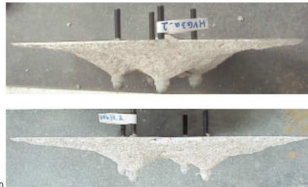
Bild 7.22: Ausbruchkörper von Vierfachbefestigung in Kalksandplanelementen mit Dübeltyp 12 für s/h_{ef} = 1,5 (oben) und s/h_{ef} = 2,3 (unten)
