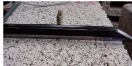
Verwölbung der Steinoberfläche nach Abbruch des Auszugversuchs
