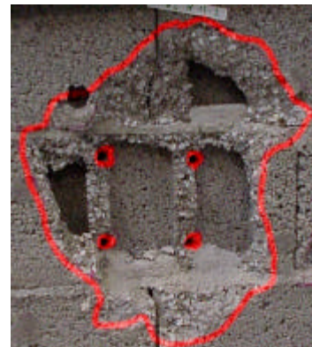
Bild 7.18: Versagensbild einer Vierfachbefestigung mit einem Achsabstand von s/h_{ef} = 1,5
