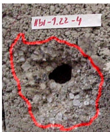
Pos. 3: c_1 = 1,0 \cdot h_{ef} Ausbruch ohne Randstörung
