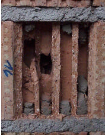
Bild 5.89: Verzeichnung des Fugenmörtels mit der Steinlochung in Hlz12-3DF
