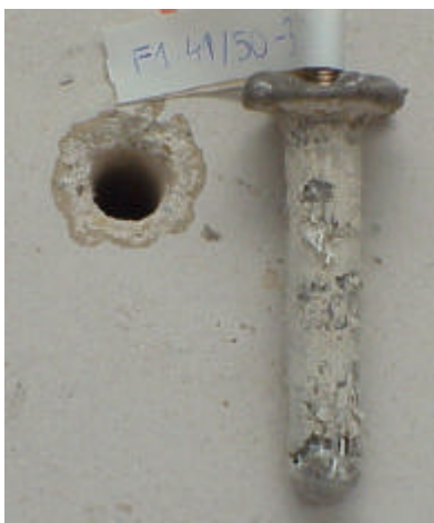
Bild 5.27: Injektionsdübel nach dem Herausziehen in Vollsteinen
