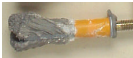
Bild 5.9: Abdichtung der Siebhülse im Stegbereich von Lochsteinen
