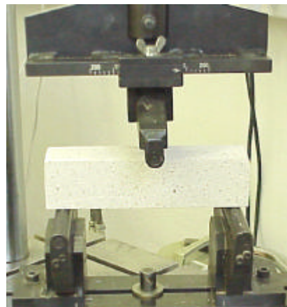
Bild 3.14: Versuchsaufbau zur Bestimmung der Biegezugfestigkeit
