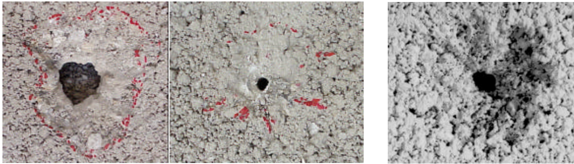
Bild 10.21: Steinschädigungen in 3K Hbl2 nach zentrischen Ausziehversuchen mit einem Versuchsaufbau nach Bild 10.6
