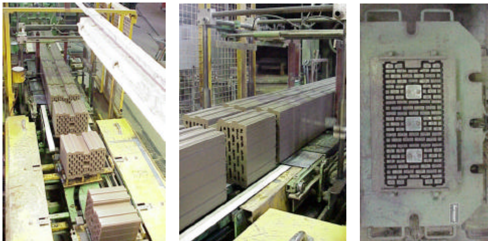
Bild 3.9: Strangpressverfahren in der Ziegelherstellung, Zuschneiden der Steine und Schablone für Hochlochziegel des Formats 16DF
