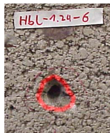
Pos. 5: c_1 = 1,8 \cdot h_{ef} Versagen Herausziehen
