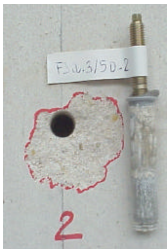
Bild 5.32: Injektionsdübel nach dem Herausziehen in Lochsteinen
