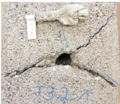
Bild 10.15: Versagensbild von 2K Hbl4-0,8-12DF bei zentrischen Ausziehversuchen mit kombinierter Abstützung
