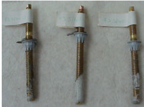
Bild 5.25: Ankerstangen nach Verbundversagen zwischen Ankerstange und Mörtel
