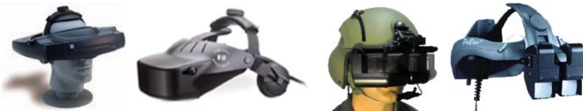
Abbildung 3.2: Eine Auswahl an Head-Mounted-Displays, die momentan auf dem Markt erhältlich sind. Vlnr: n-vision Datavisor (78 Grad FOV, 1280x1024), Virtual Research V8 (60 Grad FOV, 1920x480), Kaiser ProView 50 (augmented, 50 Grad FOV, 1024x768), Kaiser Proview 100 (augmented, 100 Grad FOV, 1024x768).
