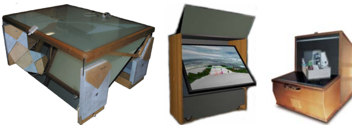
Abbildung 3.7: Die Projektionsfläche einer Workbench kann horizontal, vertikal oder variabel sein. Die Holobench (rechts) besteht aus zwei Projektionsflächen.
