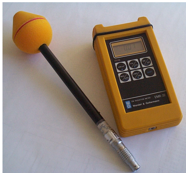
Bild 5.5: EMR-System mit E-Feldsonde Typ 9 und Auswerteeinheit EMR-20
