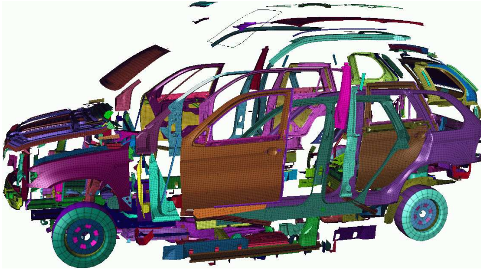
Abbildung 3.10: Die Explosionsdarstellung zeigt das Modell eines BMW X5 in der frühen Phase. Das Modell umfasst etwa 250 000 Elemente in 500 Bauteilen.
