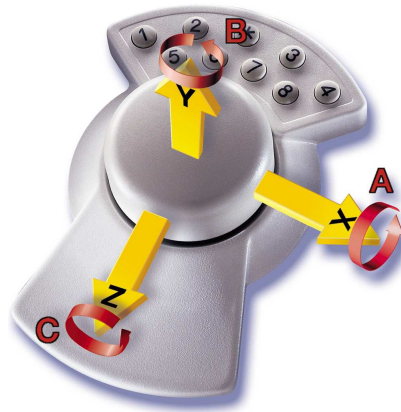
Abbildung 5.4: Mit diesem Eingabegerät, einer Space Mouse , ist es möglich, Translationen entlang beziehungsweise Rotationen um die drei Hauptachsen durchzuführen.
