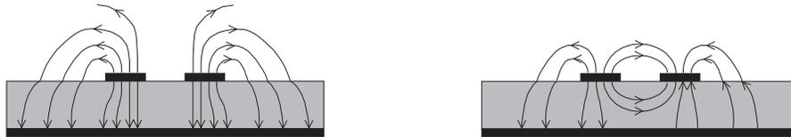
**Bild 2.14:** Prinzip des Gleich- (links) und Gegentaktes (rechts) eines Leitungskopplers.
