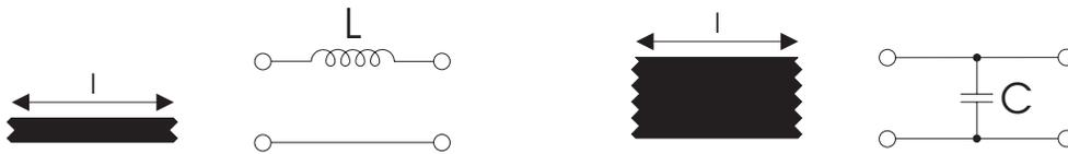
**Bild 2.10:** Schema und Ersatzschaltbild der Leitungsbreitenvariation.
