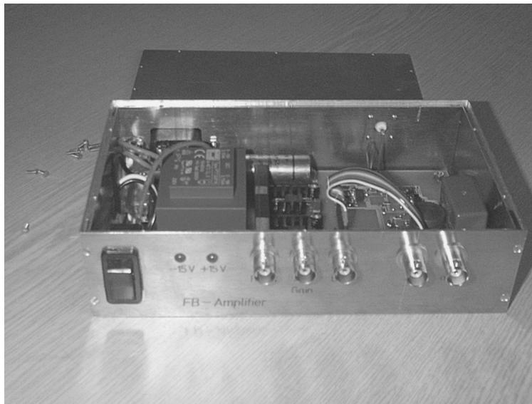
**Bild 6.4:** Foto des analogen Regelverstärkers.
