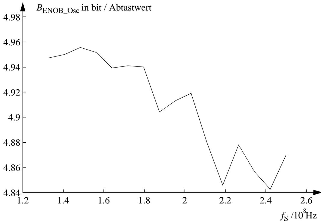
Bild 56: Effektive Auflösung des Oszilloskops DPO 7404 mit Abtastrate  $f_{A\_Osc} = 19,998\ 965\ 760$  GHz
