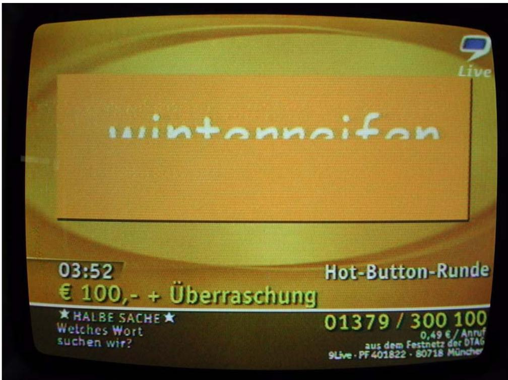
Bild 64: Fotografie des Fernsehbildes des A/D-D/A-umgesetzten BK-Signals
