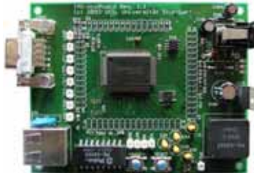
Abbildung 8.6: Mikrocontroller-Board für eingebettete Feldbus-Gateways ( IAS-WebBoard )
