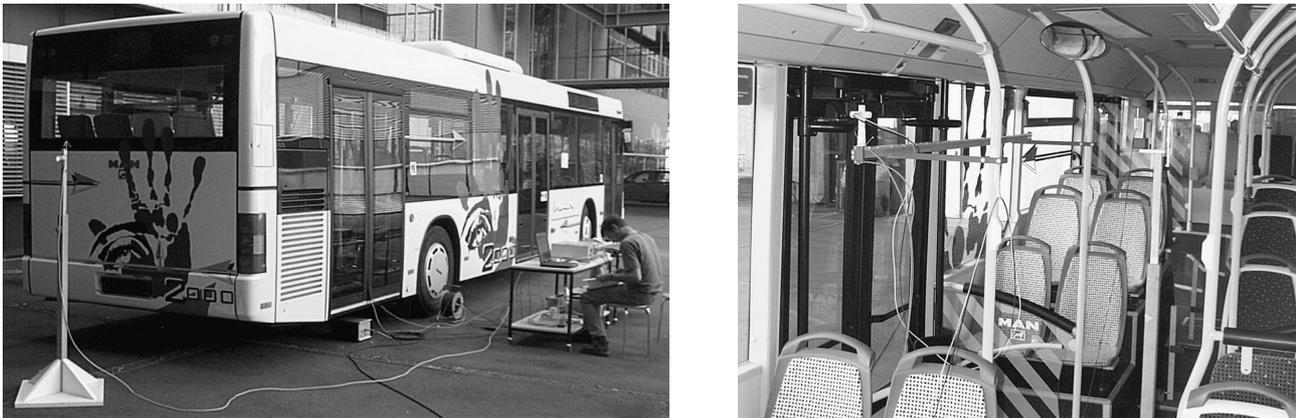
**Bild 1.7:** Aufbau zur Messung der elektrischen Feldstärke bei Mobilfunkbetrieb in einem Autobus.
