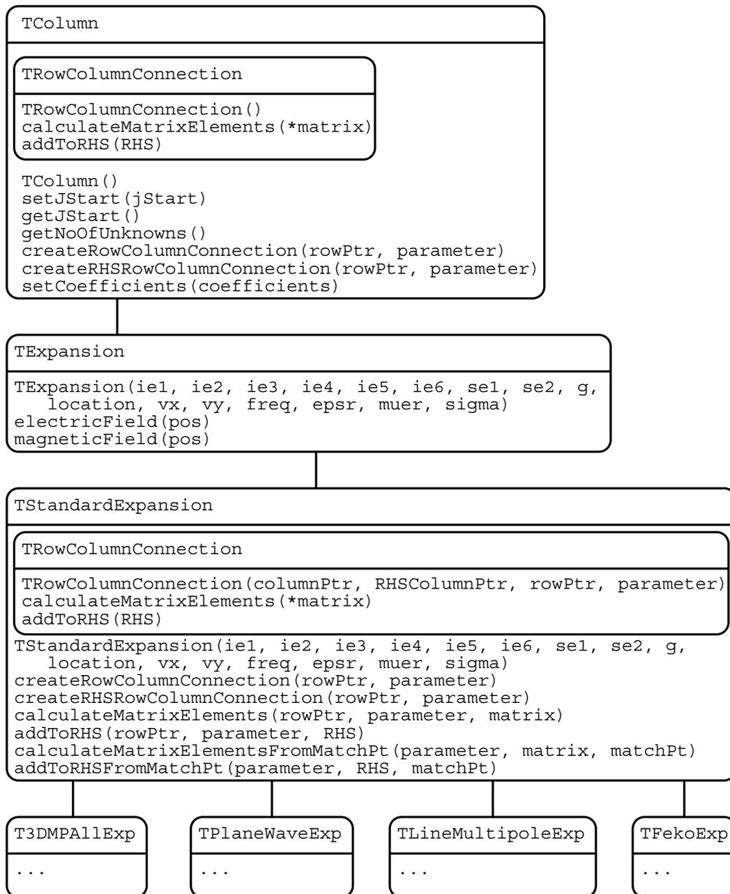
**Bild B.2:** Methoden und Ableitungen der Klasse *TColumn*.
