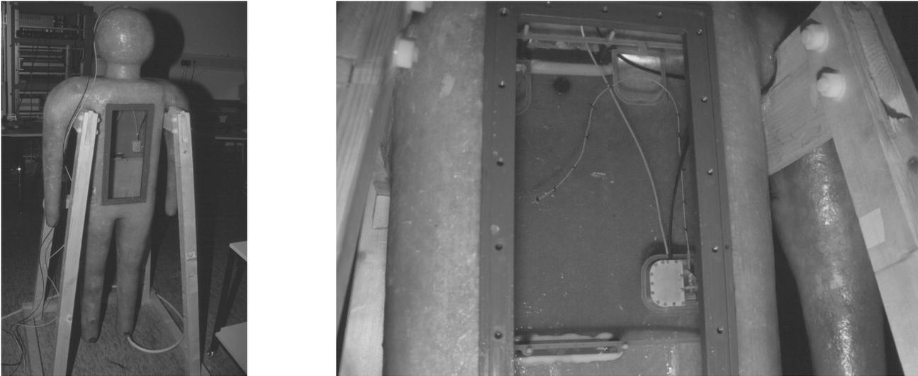
**Bild 1.4:** Körperphantom mit implantierten Mess-Herzschriftmachersystem zur Bestimmung der Einkoppelspannung bei Funkbetrieb.
