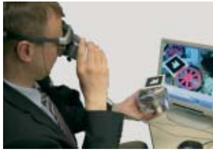
Abb. 15: Dreidimensionale Projektion der simulierten magnetischen Felder auf ein reales Modell.
