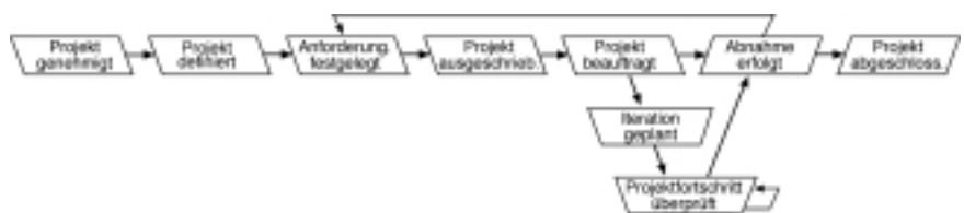
Abb. 5: Projekttablauf (aus der Sicht des Auftraggebers) nach dem V-Modell XT.
