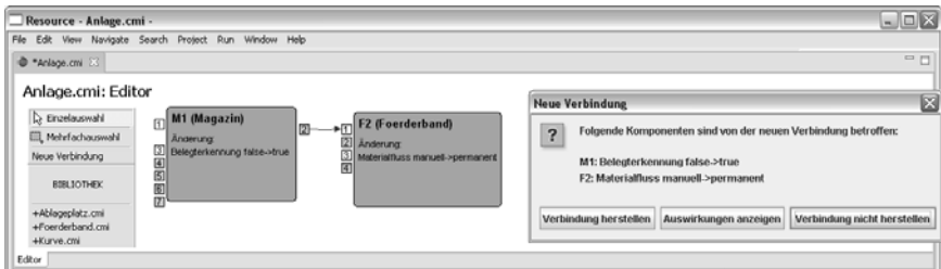
Abbildung 10.5: Ergebnis der Verbindungsprüfung mit Lösungsvorschlag
