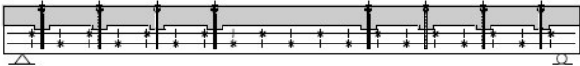
Bild 3.5: Biegeversuch [Fontana und Frangi 2000]
