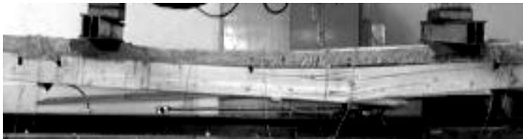
Bild 3.11: Biegezugversagen des Holzes bei Laststellung 1
