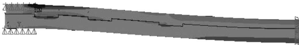
Bild 3.47: Spannungen in Längsrichtung bei teilweiser Einspannung
