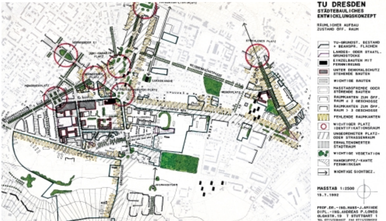
Zustand des öffentlichen Raumes im Hochschulstadtteil mit vielen Defiziten 1992: Baulinien, Straßenräume, Plätze usw.
