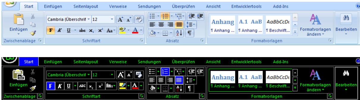
Abbildung 33 Ribbon von Word in Originalfarben (oben) und kontrastreicher Darstellung (unten) Die kontrastreiche Darstellung wurde über das Windows-Schema „Kontrast Nr. 2“ erzeugt.
