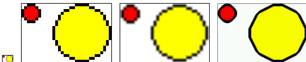
Abbildung 94 Grafik mit zwei Kreisen (wie in Tabelle 8 rechts) in Originalgröße und in 9-facher Vergrößerung mit verschiedenen Algorithmen v.l.n.r.: Nearest-Neighbor, Bilineare Interpolation, 2-fache Anwendung von Hq3x
