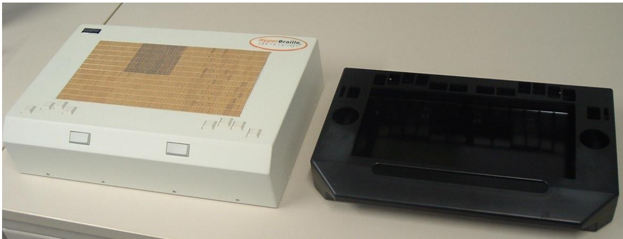
Abbildung 123 Gehäuse des neuen grafisch-taktilen Displays der Firma Metec (rechts) im Vergleich zum BrailleDis 9000 (links) Das neue Display wiegt lediglich 5 kg und kann in einem Rucksack transportiert werden.
