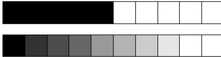
Abbildung 4.2: oben: ideale Stufenkante: Kante am Helligkeitsübergang klar erkennbar. unten: abgestufte Helligkeitsübergänge: Kante nicht klar erkennbar.
