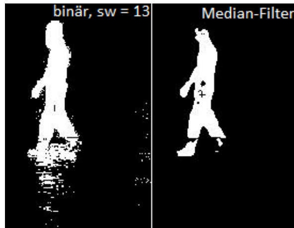
Abbildung A.3.: Links: Binärbild mit Störungen, Rechts: Die Störungen mithilfe eines Medianfilter beseitigt. Quelle: [hgS]
