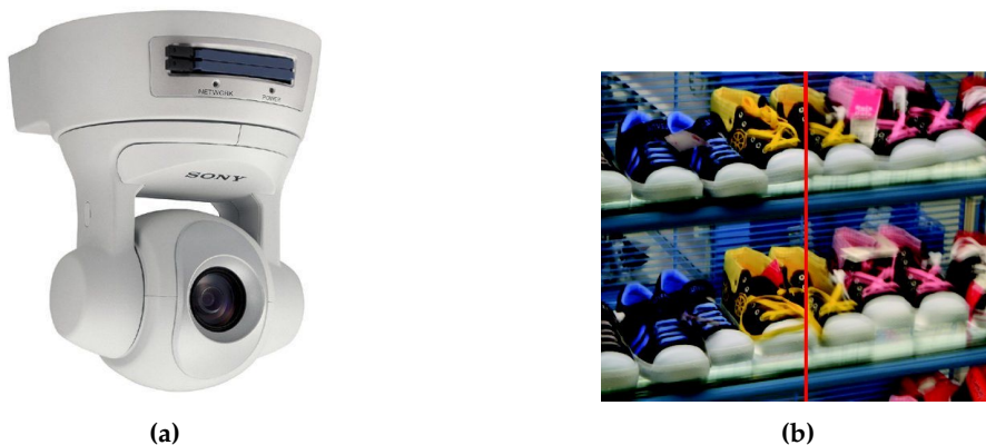
Abbildung 1.2.: (a) PTZ-Kamera "SONY SNC-RZ30", (b) Bild mit und ohne Bewegungsunschärfe. Quelle: (a)Benutzerhandbuch von SONY SNC-RZ30 (b)[CLog]
