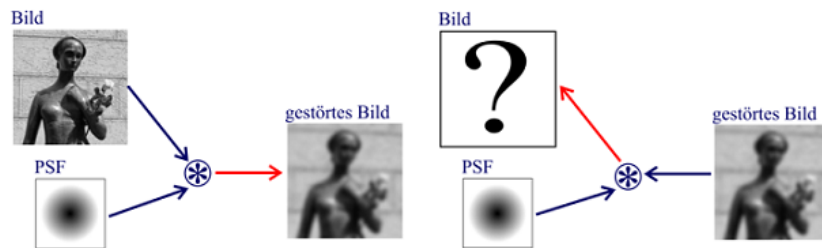
Abbildung 5.1.: Links: Faltung des idealen Bildes mit PSF. Rechts: Entfaltung des unscharfen Bildes mit PSF [Wik11c]
