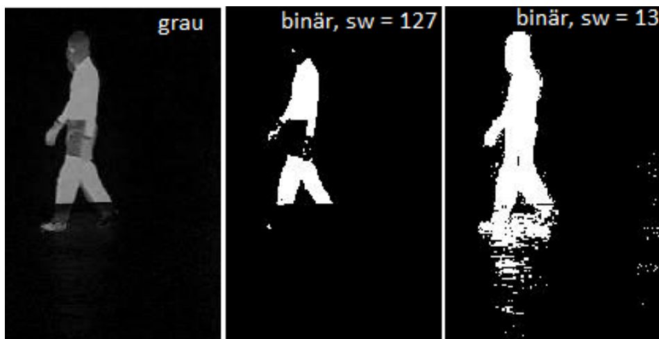
Abbildung A.2.: Links: Differenzbild, Mitte: Binärbild bei einem großen Schwellenwert, Rechts: Binärbild bei einem kleinen Schwellenwert. Quelle: [hgS]
