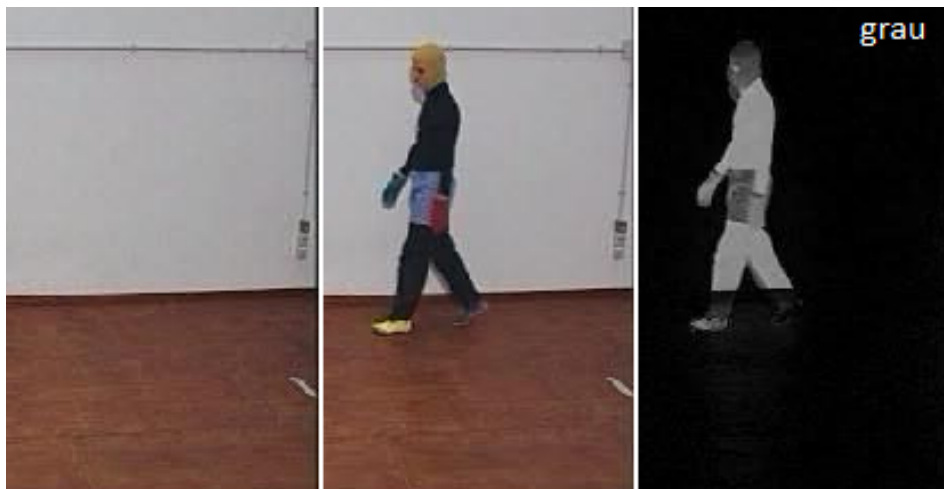
Abbildung A.1.: Links: Hintergrundbild, Mitte: Einzelbild, Rechts: Differenzbild. Quelle: [hgS]
